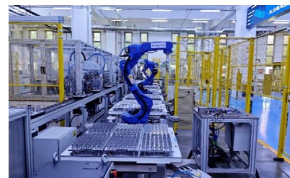
电液控换向阀阀芯柔性装配生产线
